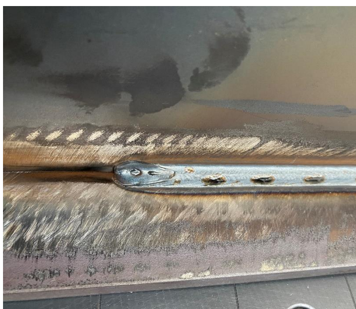
Figura 11 – Saldatura ad angolo eseguita con ArcDrive
